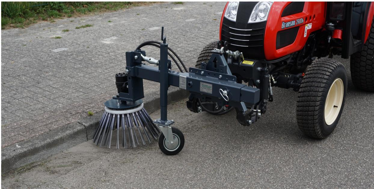
Die hydraulisch angetriebene Wildkrautbürste, geeignet für Kommunalfahrzeuge, Bagger und Traktoren.
